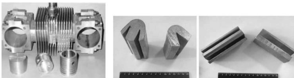
Рис.2. - Приклади виробів, отриманих надпластичної точної обсягної штампуванням на основі реалізації сверхпластичности алюмінію і його сплавів: а - виріб типу «поршень»; б - струмозійомники для електротранспорту з високою зносостійкістю [4]
