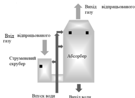
Рисунок 1. Принципова схема, що поєднує струменевий скруббер та абсорбер.
